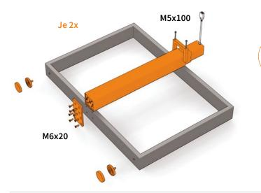
Lochplatte mit dem Fußausleger verschrauben. Hubsäule auf den Fußausleger auflegen. Metallbügel oben in Fußausleger einstecken. Mit zwei Schrauben anziehen.
