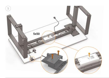
Hubsäulen mit Steuereinheit verkabeln. Die Form der Stecker sichert die richtige Verkabelung. Steuereinheit in der Mitte des Tischgestells befestigen.
