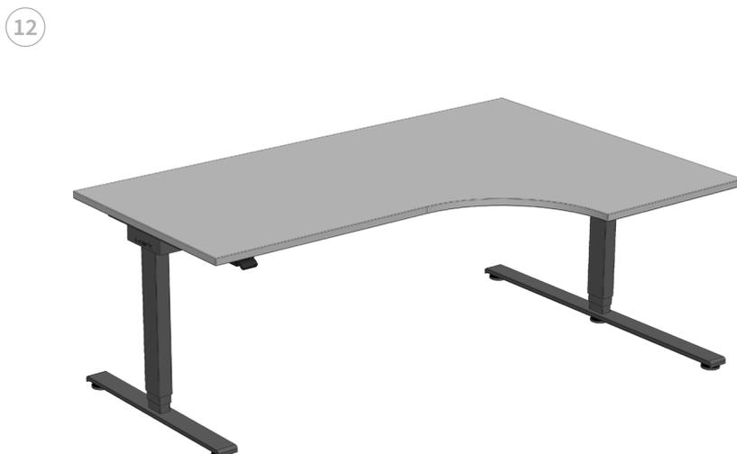
Tisch mit **2 Personen** aufstellen und über Nivelliergleiter ausrichten. Bodenkontakt aller Gleiter sicherstellen.
