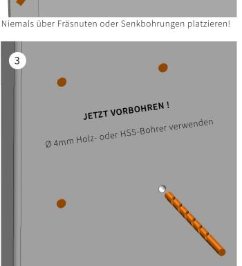
Löcher 5-10mm tief bohren. Fläche staubfrei halten!
