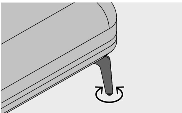
Ausgleich von Bodenunebenheiten über die Stellgleiter. Leveling of unevenness of the floor via the adjustment gliders.
