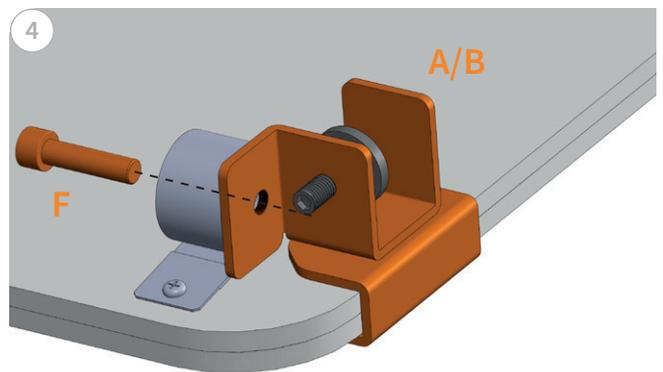
Rollfeder mit der Halterung verschrauben. Dabei ca. **1 mm Abstand einhalten** – die Rollfeder muss frei rotieren können.
