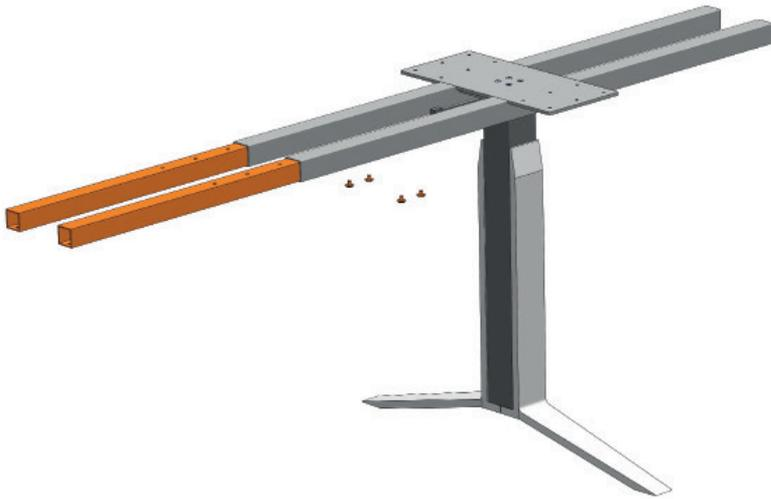
Traversen-Innenrohre in Plattenträger einschieben (**Gewindelöcher zeigen zum Boden**) und leicht festschrauben.
