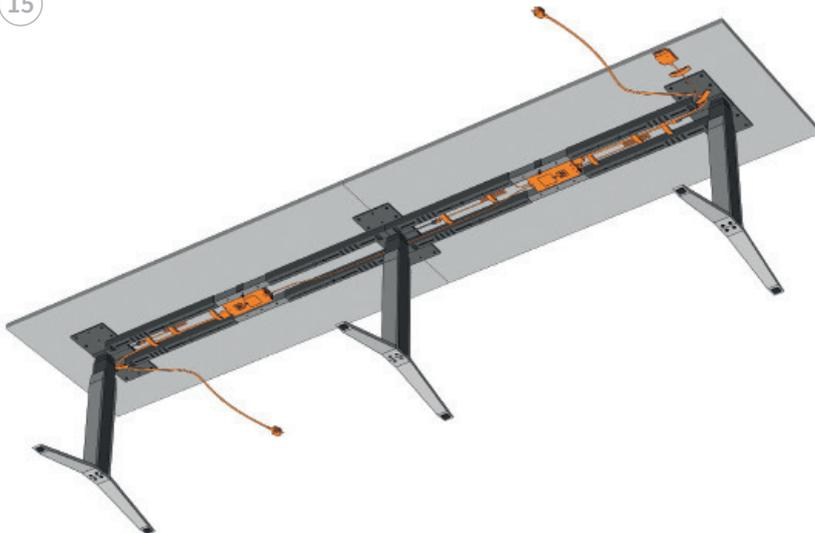
Alle Hubsäulen mit Steuereinheiten
