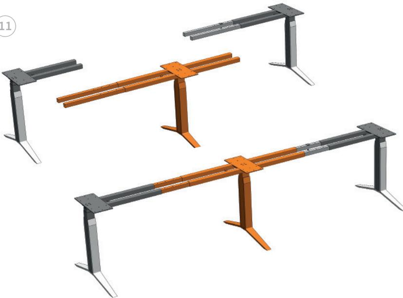
Zusammenführung der einzelnen fertig vormontierten Baugruppen zu einem zusammenhängenden Tischgestell erfolgt direkt am vorgesehenen Standort. Ein nachträgliches Verrücken bzw. Vertragen ist nicht mehr möglich!
