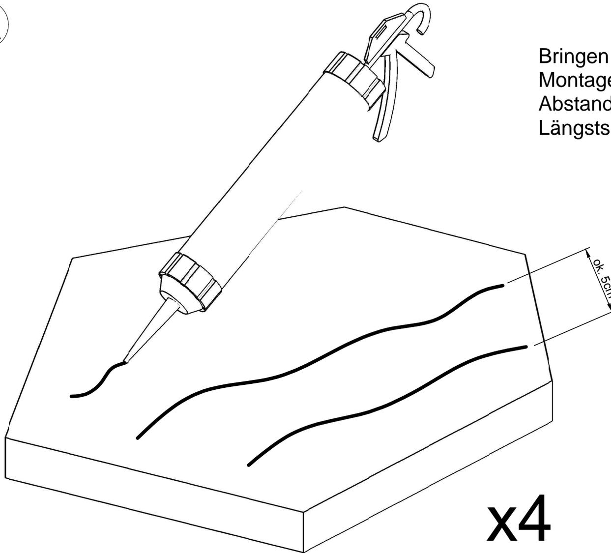
Bringen Sie 4 Streifen Montagekleber (Breite ca. 1-2 cm) im Abstand von ca. 5 cm über die Längsseite der Platte an.
