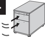
Demontage/Montage der Griffe mittels Schrauben **S1** (M4 x 25) bzw. **S2** (M4 x 12) von den Innenseiten der Schubladenblenden aus vornehmen
