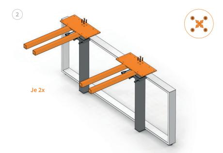
Plattenträger mit Hubsäulen verschrauben. Schrauben **mehrfach über Kreuz kräftig festziehen.**
