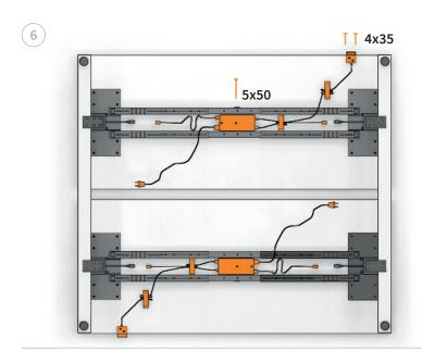
Hubsäulen und Steuereinheit verschrauben. Die Form der Stecker sichert die richtige Verkabelung.
