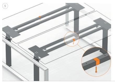
Die Justierschraube ist für Tischplatten ab 1800 x 800 mm sinnvoll. Damit wird die Form-Stabilität der Tischplatte erzielt.
