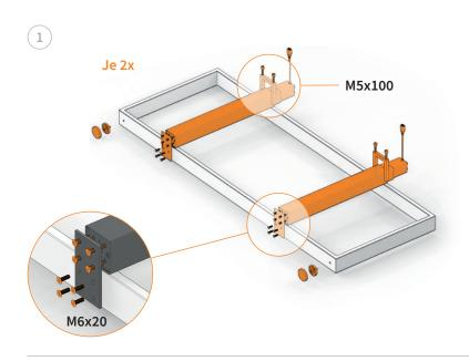
Säulen vorsichtig auf das Seitenteil auflegen. Kabel wie in Abbildung ausrichten. Schrauben unten handfest eindrehen.
