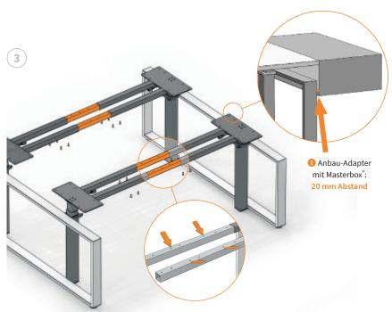
Beim Anbau-Adapter mit aufgeschobener Masterbox® muss das Tischgestell min.
