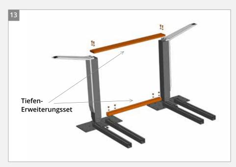
Für die Tiefenerweiterung werden die Hubsäulen mit einem Fußausleger bestückt.
