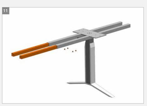
Teleskop-Innenrohre in Plattenträger einschieben (Gewindelöcher zeigen zum Boden) und leicht festschrauben.
