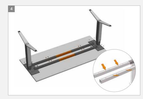
Teleskop-Innenrohre mit Gewindelöchern nach oben zeigend in die Plattenträger einschieben und je Seite doppelt verschrauben. Rahmengestell auf Tischplatte ausgerichtet anschrauben.
