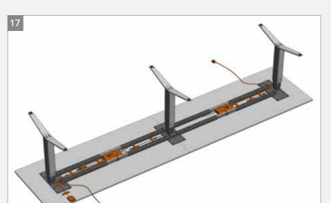
Alle Hubsäulen mit Steuereinheiten verkabeln. Die Form der Stecker sichert die richtige Verkabelung. Netzkabel an Steuereinheiten anschließen. Handschalter kann wahlweise an eine Steuereinheit angeschlossen werden.
