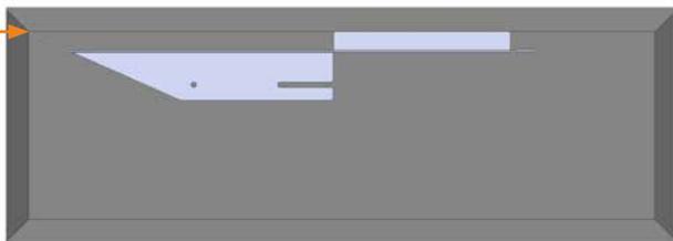
Hitzeschutzblech in Position bringen. Die vordere Abkantung des Blechs mit der Gehrungskante des Gehäuses sollte bündig verlaufen!
