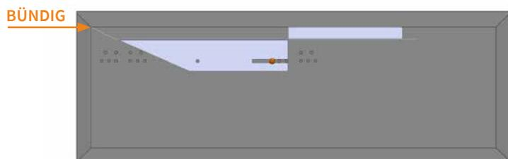
Hitzeschutzblech vorsichtig auf die beiden Blechschauben aufschieben bis die vordere schräge Abkantung mit der Gehrungskante des Schubladengehäuses bündig verläuft.
