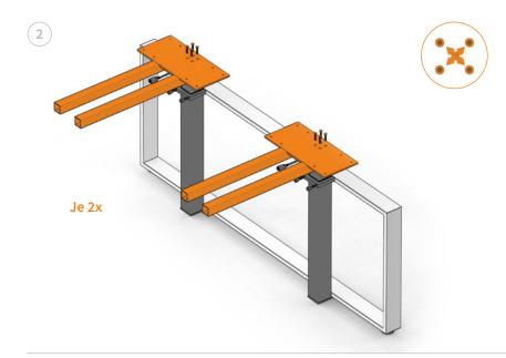
Plattenträger mit Hubsäulen verschrauben. Schrauben **mehrfach über Kreuz kräftig festziehen.**
